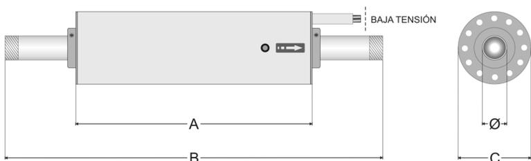
PLR modelo 027FI - Debe ser instalado en espacios cerrados protegido contra las inclemencias del tiempo. El sistema hidráulico de la que se inserta debe tener una conexión a tierra conforme a lo dispuesto por la ley. En condiciones de ventilación insuficiente y bajo caudal de agua la superficie puede estar caliente.
